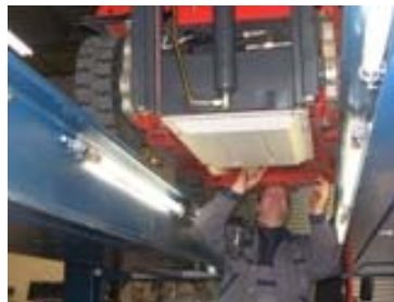
Unter der Vorderachse des Staplers wird die robuste RFID-Antenne montiert.
